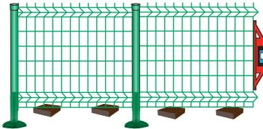
Placez le deuxième piquet sur le pied et contrôlez que le piquet soit bien droit. Placez le poteau profilé sur le pied et introduisez avec beaucoup d'insistance (placé sur le sol verticalement) le poteau en travers du pied jusqu'à arriver à l'hauteur du panneau déjà fixé ou jusqu'à arriver à la base du pied.
